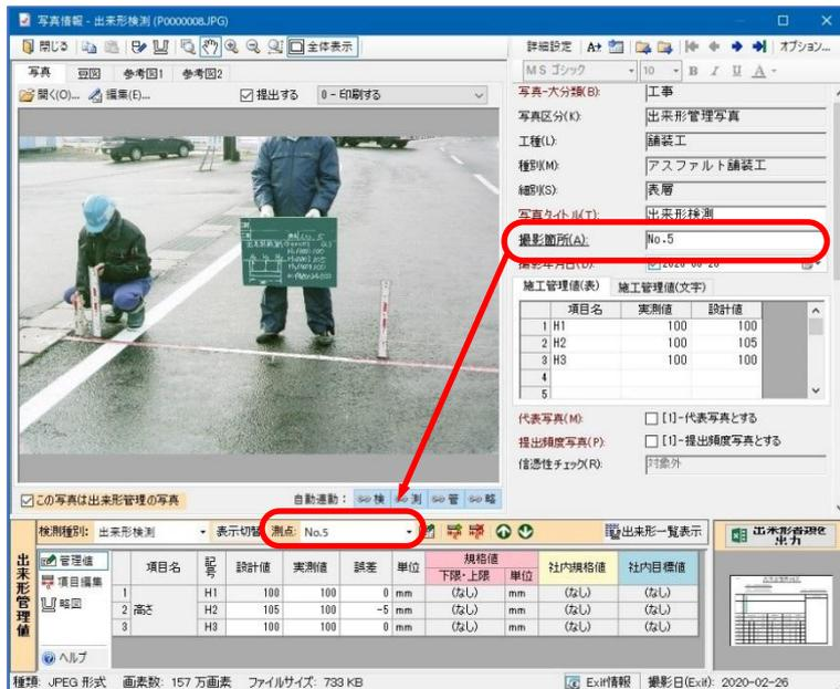
■写真タイトル・撮影箇所は、写真情報ウィンドウで編集し、すでに入力済みの場合も検測種別、測点として出来形管理情報エリアに追加されます。
