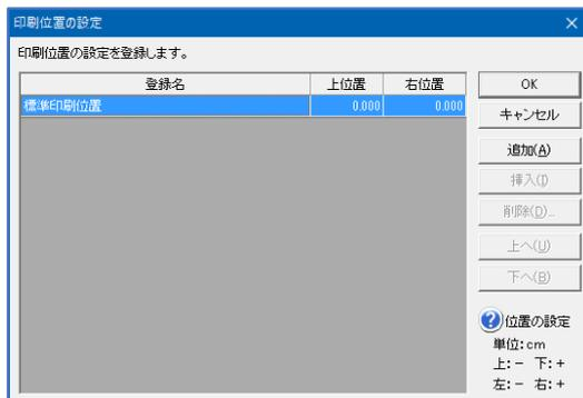
■ 印刷位置は cm 単位で設定します。上に移動したい場合はマイナス、下に移動したい場合はプラス、左に移動したい場合はマイナス、右に移動したい場合はプラスの数字を入力します。印刷位置の設定はプレビュー画面でも行えます。
