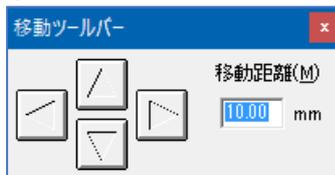
③移動ツールバーの移動距離を入力します。
